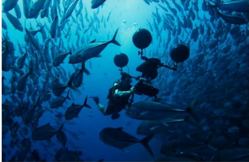
Investigadores marinos usando un arreglo de hidrófonos (Micrófonos acuáticos) para escuchar los peces.
